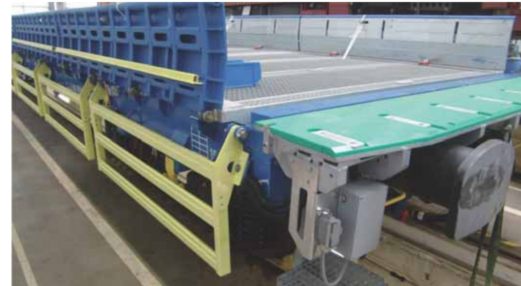
Be- und Entladewagen mit Notabstieg über die gesamte Fahrzeuglänge kurz vor Fertigstellung.
