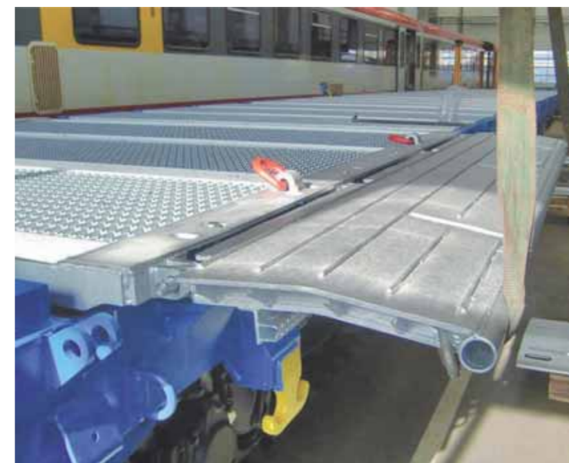
Montage der befahrbaren Seitenklappe.
